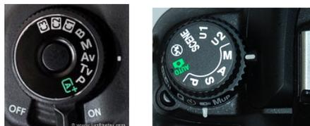
Avec une molette : en mode M, elle change la vitesse. Il faut appuyer sur +/- pour régler l'ouverture.
